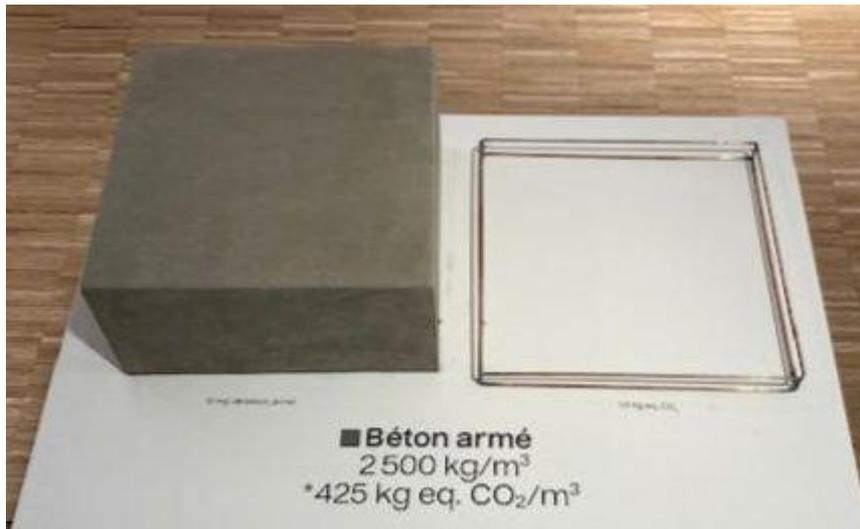
Béton Armé – 2.500 kg/m<sup>3</sup> – 425 kg eq CO<sub>2</sub>/M<sup>3</sup>
